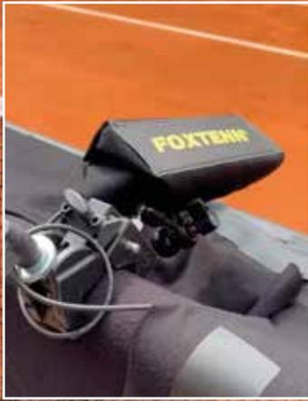
An den Enden der Linien waren Kameras von FOXTENN angebracht. Jeder Ball wurde von bis zu fünf verschiedenen Sensoren (Kameras oder Laser) registriert. Fotos: Seventyfour.studio
